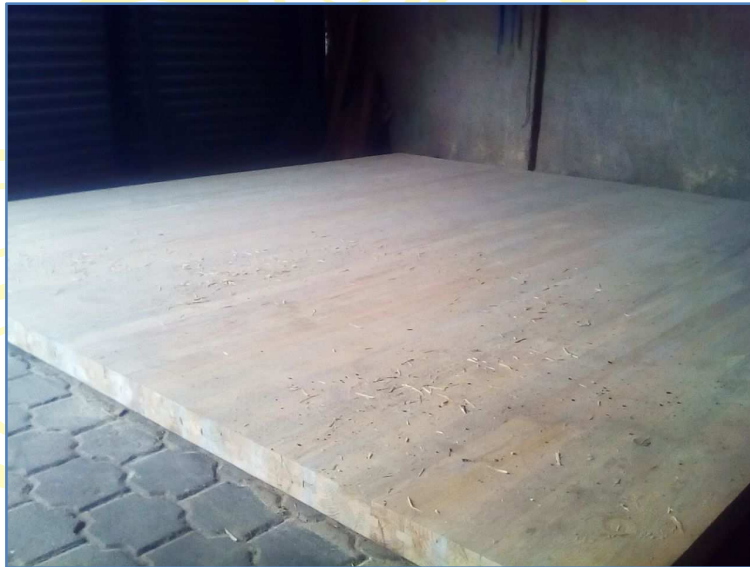
Fabricación de tarimas para entrenamiento de levantamiento de pesas, conformada de piezas de madera de 4 pulgadas x 4 pulgadas x 2.44 metros.
